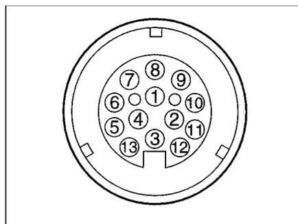
Bild 104 Sicht auf Steckdose Zugfahrzeug (dreizehnpoliges System Jaeger nach DIN EN 1648-1)
