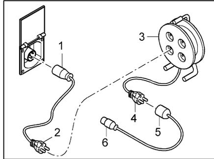
Bild 98 Anschlussmöglichkeiten 230-V-Anschluss
