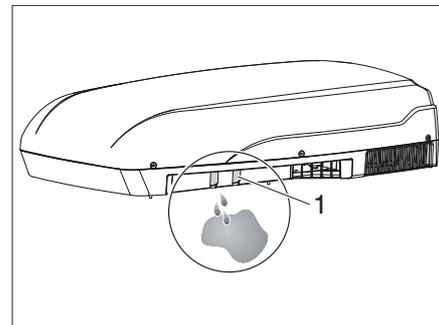
Bild 173 Kondenswasserablauf Klimaanlage
