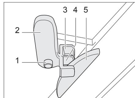
Bild 49 Heki-Dachhaube in Lüftungsstellung 1
