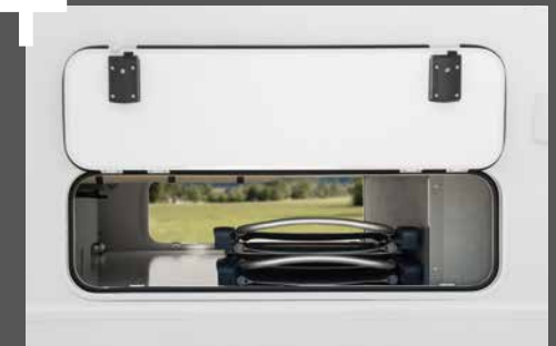
Frostgeschützt: beheizter Doppelboden mit viel Stauraum.
