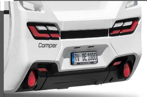
Moderner Heckleuchtenträger mit LED-Leuchten
